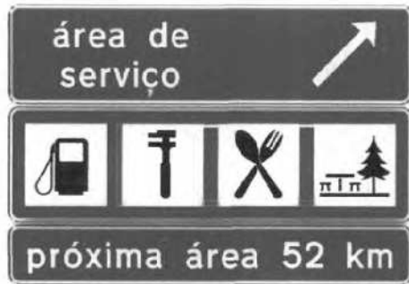
13b Aproximação de via de saída para área de serviço
