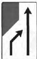
ST2b - Circulação de tráfego afectada por obstrução
